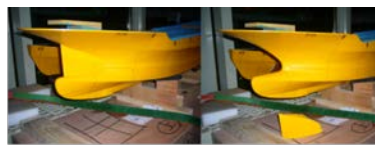
上: 船首付加物による波浪中抵抗増加の低減(約-20%) 左2図: 隻数を減らし大型化すると、安全性が高く労働生活環境の良い漁船となり、個船の船価は増加するものの、全体の投資コストは減少
