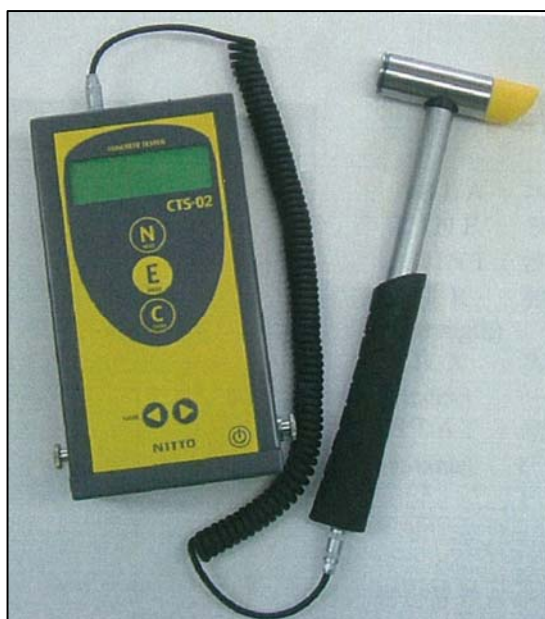
図1 機械インピーダンス法のインパルスハンマーと測定装置
