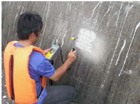
写真1 機械インピーダンス法の実施状況
