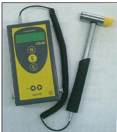
図3 機械インピーダンス法のインパルスハンマーと測定装置の例（例；CTS）
