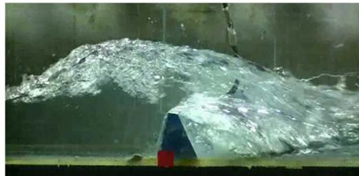
図 1 構造物に作用する津波波力を把握するための水理模型実験（左側：防波堤、右側：防潮堤）
