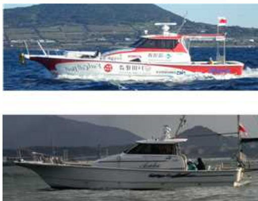
図1 実験に使用した水素燃料電池船(上)とディーゼルエンジン船(下)
