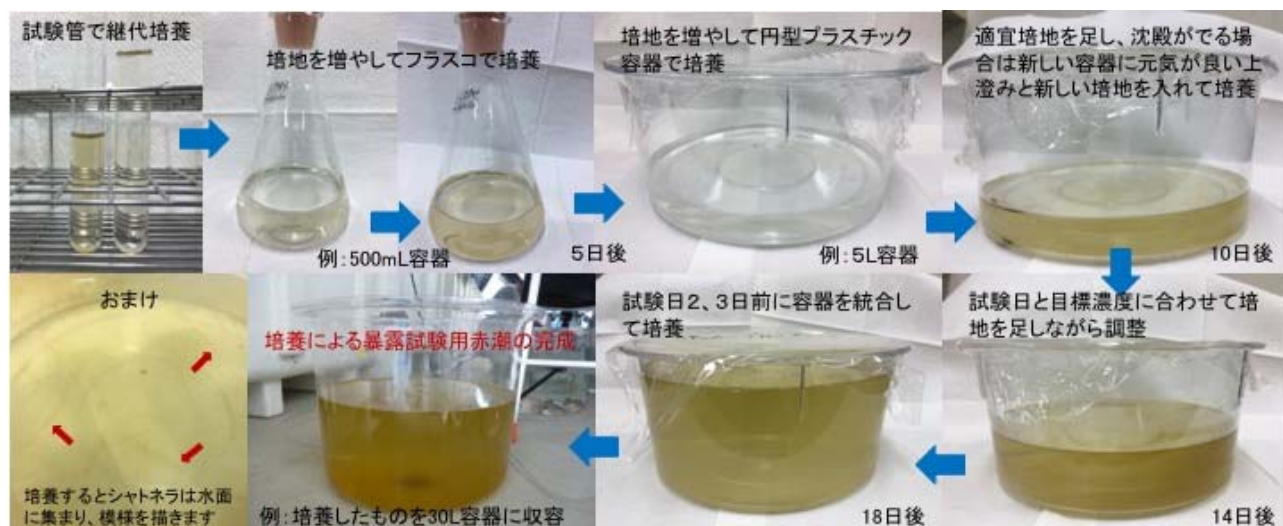
図 試験管からフラスコ、プラスチック製透明容器を用いて高濃度の赤潮を大量に培養する方法例
