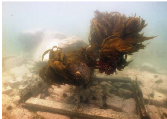
設置後3年半経過し、アラメに被われた試験装置
