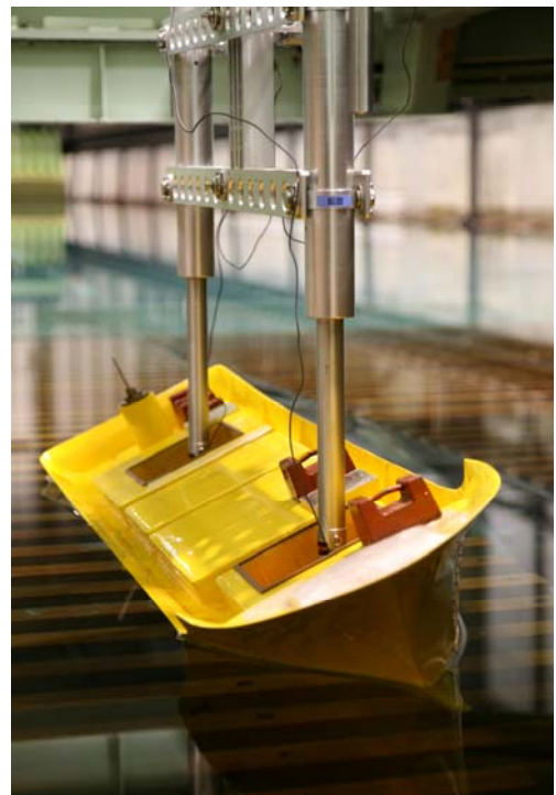
写真：大傾斜波浪中流体力計測システム
