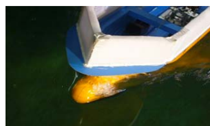
船首バルブ後方の空気巻き込みの様子
