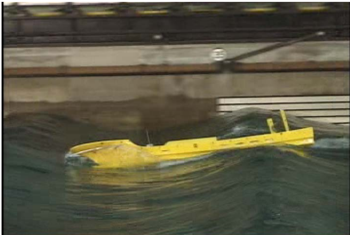
写真：追波中を高速航行するまき網漁船の模型船
