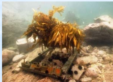
磯焼け海域において、波を利用してウニの食害を防ぎ海藻群落の形成を図る「揺動装置」
